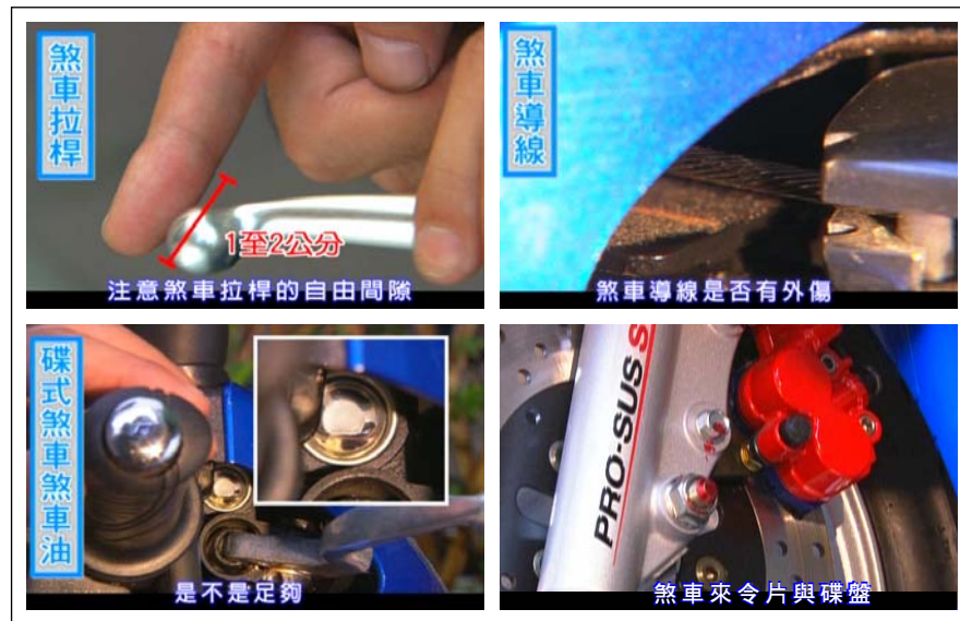
圖 2-1 煞車系統的檢查 [4]
